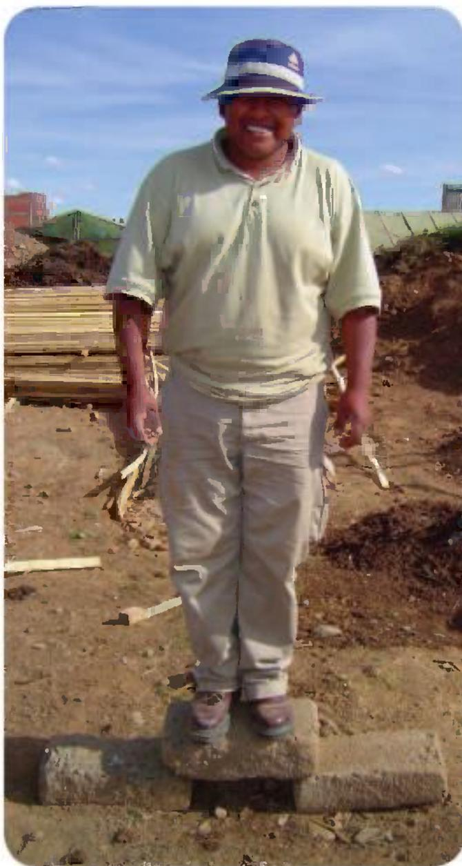
**17** Antes de utilizar, realizar prueba de la resistencia o calidad del adobe.
